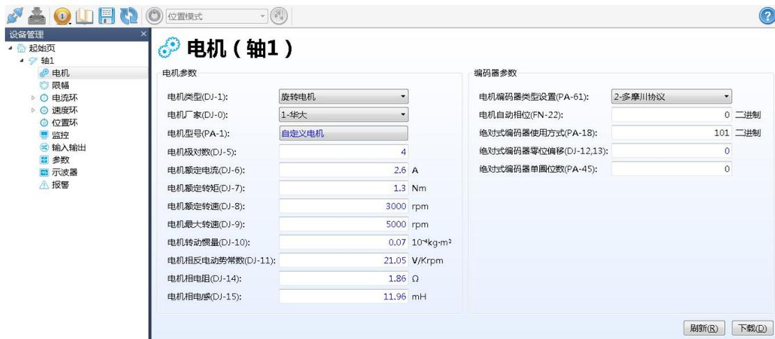
上图为 STP 软件显示的电机菜单,修改此界面的参数时,需将“参数”栏的 PA0 改为
