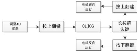
说明：电机运行速度由 PA21 决定，“长按确认键”时伺服使能自动打开，按返回键使能关闭。
